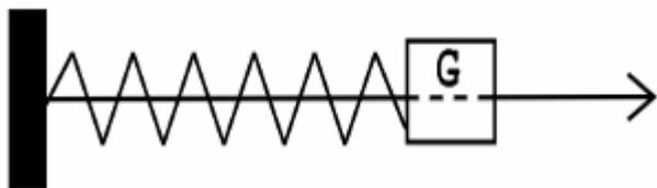
Le mouvement du cylindre le long de la tige s'effectue avec frottement visqueux dont la somme des actions est représentée par une force unique  $\vec{f} = -\alpha \cdot \vec{v}$  où  $\vec{v}$  est la vitesse instantanée du centre d'inertie  $G$  du cylindre. On écarte  $G$  d'une distance  $x_0=+5\text{cm}$  puis on l'abandonne sans vitesse initiale à une date prise comme origines des dates.
