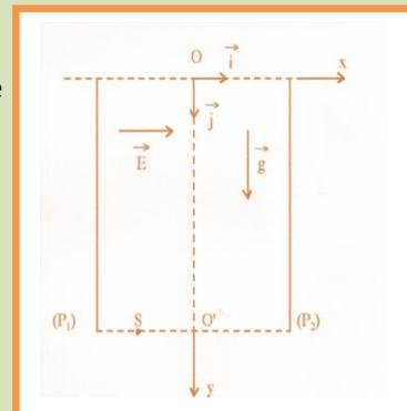
La tension entre les armatures du condensateur est  $U = 1000 \text{ V}$ . Il règne concomitamment à l'intérieur des armatures le champ de pesanteur  $\vec{g}$  et un champ électrique  $\vec{E}$  dont le sens est précisé sur la figure ci-contre.
