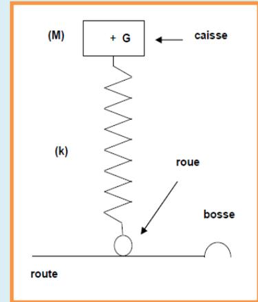
**II-1-6** On considère la caisse de la voiture de masse  $M = 1095 \text{ kg}$  à l'arrêt, sans passager. Le ressort est alors comprimé. Faire l'inventaire des forces qui s'exercent sur la caisse et les représenter sur un schéma. Etablir l'expression du raccourcissement  $\Delta l_0$  du ressort en fonction de  $k$ ,  $M$  et l'intensité de la pesanteur  $g$ .
