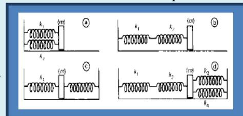
Déterminer dans chaque cas la période des oscillations de la masse  $m$  et la constante de raideur du ressort équivalent (ressort unique qui provoquerait des oscillations de même période).
