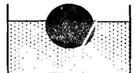
**Rappel :** Le théorème d'Archimède stipule que : tout corps plongé dans un liquide subit de la part de celui-ci une force verticale, dirigée vers le haut, d'intensité égale au poids du liquide déplacé :  $F = \rho_{\text{liquide}} \times V_{\text{liquide déplacé}} \times g$ .
