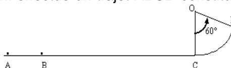
AB et BC sont rectilignes.  $AC = 350$  m. CD est un tronçon circulaire de rayon  $OC = 5$  m.
