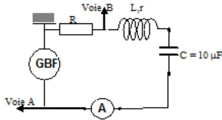
On fait varier la fréquence  $f$  du générateur BF et on relève l'intensité efficace  $I$  du courant. On obtient les valeurs suivantes :
