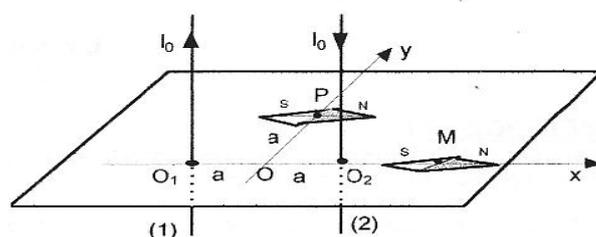
On rappelle qu'un fil rectiligne infini, parcouru par un courant crée en un point M' de l'espace un champ magnétique de valeur  $B = \frac{\mu_0}{2\pi} \cdot \frac{I}{d}$ , où d est la distance de M' au fil.  $\mu_0 = 4\pi \cdot 10^{-7} \text{SI}$  ;  $2a = 20 \text{cm}$  ;  $B_h = 2 \cdot 10^{-5} \text{T}$ , composante horizontale du champ magnétique terrestre.
