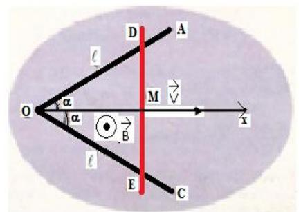
On donne :  $B = 0,3 \text{ T}$  ;  $r = 0,1 \Omega \cdot \text{m}^{-1}$  ;  $V = 0,5 \text{ m} \cdot \text{s}^{-1}$  ;  $\alpha = 25^\circ$ .
