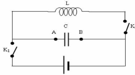
Calculer la charge maximale du condensateur et préciser sur la figure l'armature qui s'est chargée positivement.
