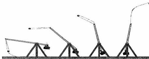
Les mouvements du contrepoids et du projectile s'effectuent dans un champ de pesanteur uniforme.
