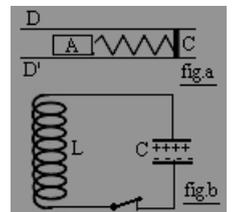
a. Etablir l'équation différentielle du mouvement de A, en prenant comme variable l'élongation  $x$ , du solide A.
