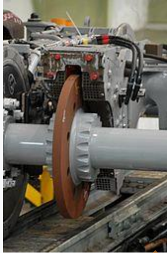
Frein à courants de Foucault sur un train rapide japonais Shinkansen .
