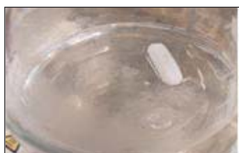
Figure 5. Recristallisation avec éthanol : sur plaque chauffante, dissolution totale du solide.
