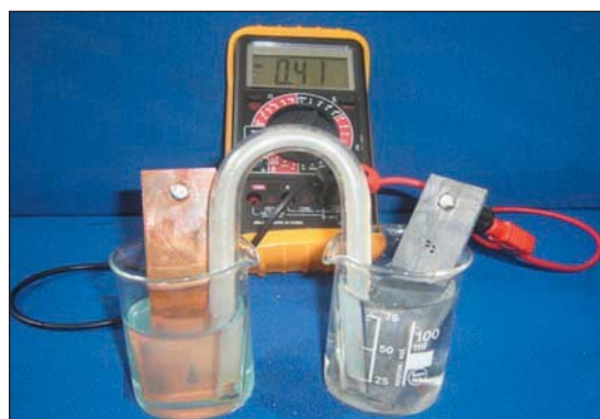
b) Mesure de la f.é.m. de la pile ( P_b ) après dilution.
