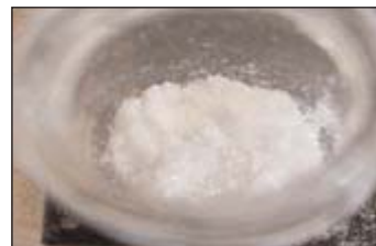
Figure 7. Résultat obtenu après nouvelle filtration sur Büchner: cristaux d'acide acétylsalicylique.
