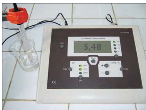
Figure 4. Mesure du pH de la solution d'acide éthanóique 10^{-2} M.
