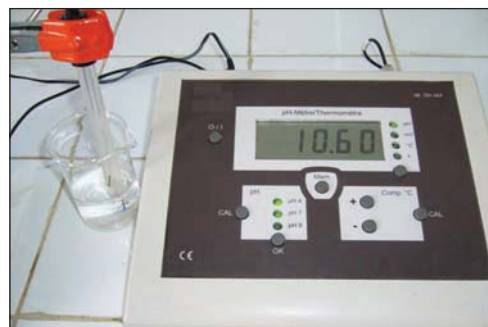
Figure 5. Mesure du pH d'une solution aqueuse d'ammoniac.
