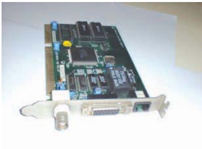
Fig.5 : Une carte réseau à différentes connexions RJ45, BNC et série
