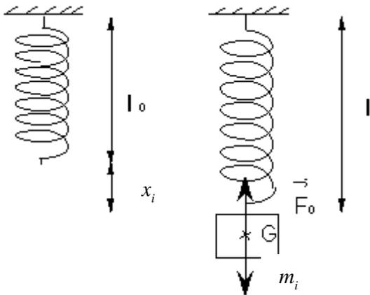
Un élève de seconde C réalise une expérience au laboratoire dont le but est la détermination d'une constante  $k$  d'un ressort. Au bout de ce ressort, il accroche des charges marquées  $m_i$  de différentes valeurs en **kilogramme**.
