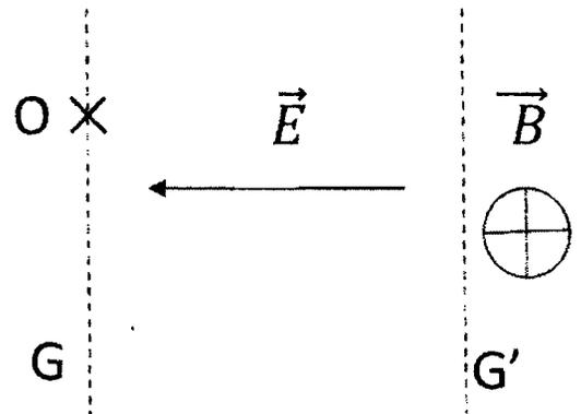
3- Après avoir traversé la grille G', les ions entrent dans une région où règne un champ magnétique uniforme  $\vec{B}$  horizontal, perpendiculaire au plan de la figure. Voir schéma.
